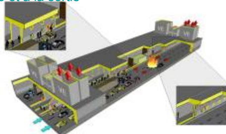
Option n° 8 Longitudinale (transitoire) avec ventilateurs VE à l'entrée et à la sortie
